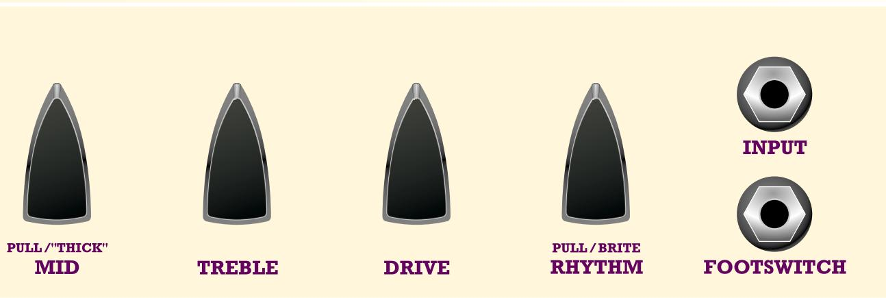
**Treble:** Mit diesem Regler können Sie die Höhen einstellen. Die Einstellungen dieses Reglers hängen normalerweise von Ihrer Pickup-Konfiguration ab; Single Coils benötigen weniger Höhen, während Gitarren mit Humbucker mehr Höhen benötigen.
